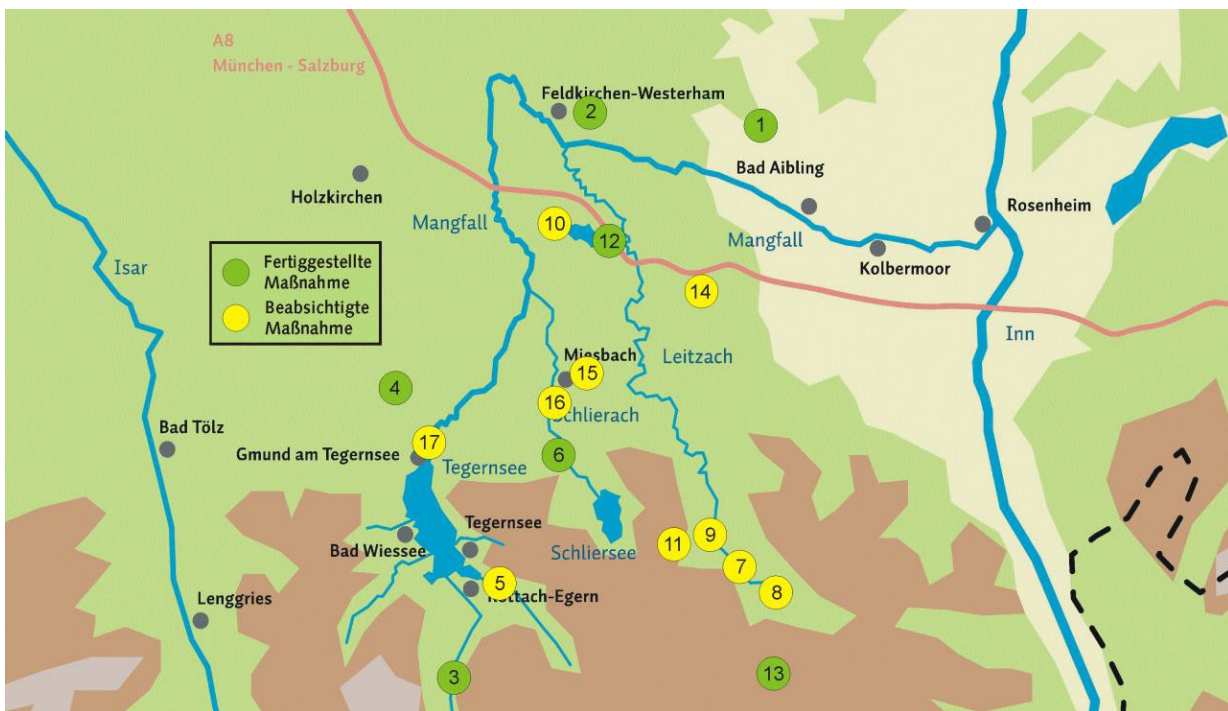
Abbildung 2: Maßnahmen zum Rückhalt in der Fläche im Einzugsgebiet der Mangfall
